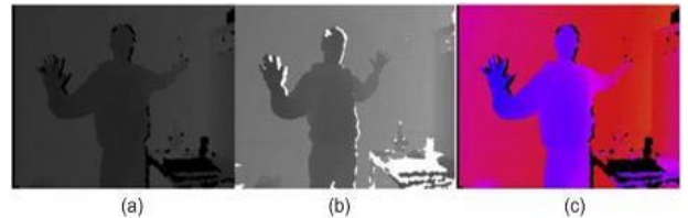
Gambar 4. Perbaikan tingkat depth image : (a) kedalaman citra asli, (b) perbaikan tingkat keabuan, (c) pemberian color depth pada aras keabuan
