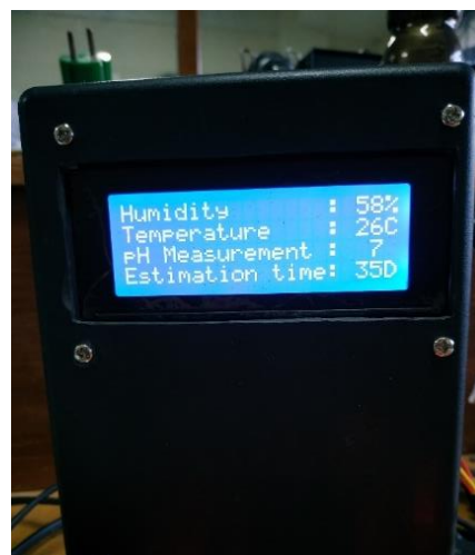
Gambar 19 Hasil Pengujian LCD 20x4
